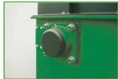
Neu entwickelte, robuste Flanschlager gewährleisten hohe Lagerstandzeiten.
