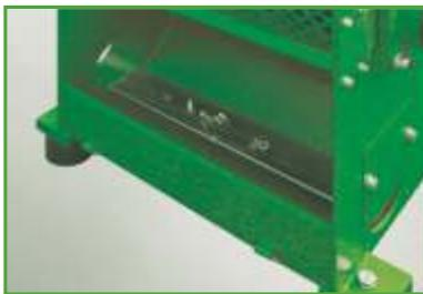
Metallische Fremdkörper wie Nägel, Schrauben oder Metallklammern können nach der Zerkleinerung über einen optionalen Permanentmagneten ausgesondert werden.
