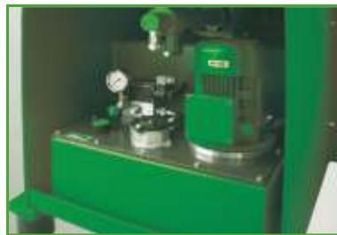
Das Hydraulikaggregat ist vollständig im Maschinenkörper integriert. Der Hydraulikzylinder ist kardanisches gelagert, wodurch eine lange Lebensdauer sichergestellt wird.
