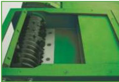
Über den serienmäßig installierten Hydraulik-Schieber wird das Material lastabhängig gegen die Rotorwelle gedrückt. Die Abstreiferleisten verhindern, dass dünnes Material sich zwischen Schieber und Maschinentisch verklemmen.
