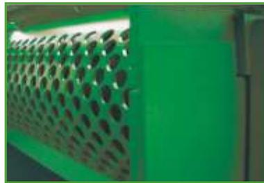
Die Größe der Hackschnitzel wird über die eingesetzte Sieblochung bestimmt. Die Auslegung der Sieblochgröße erfolgt in Abhängigkeit der weiteren Verwendung der Hackschnitzel.
