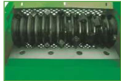
Der Einsatz von konkaven Schneidwerkzeugen (vierfach wendbar) ermöglicht eine hohe Zerspanleistung auch bei harten Materialien.
