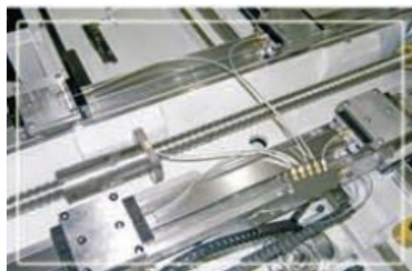
Centrální mazání válečkového vedení a přesných kuličkových šroubů
