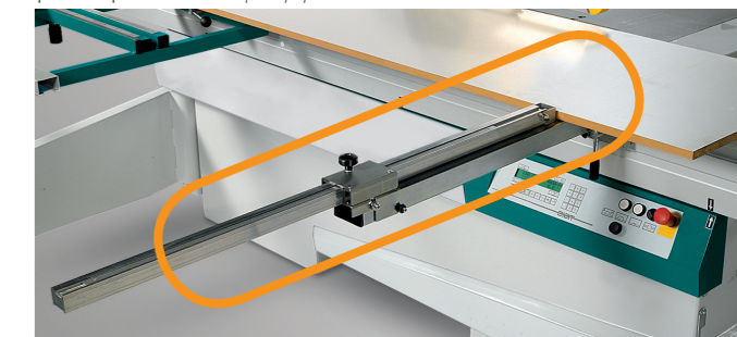
Option Pianetto tagli paralleli / Small table for parallel cuts / Tablette pour coupes parallèles / Kleine Platte für gleichlaufende Schnitte / Mesa para cortes paralelos / Приставка для параллельных резов
