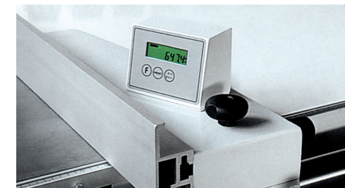
Option Lettore elettronico posizione della guida parallela / Electric display of the rip fence positioning / Lecteur électronique position du guide sur la table / LED-Anzeige der Position des Parallelanschlags / Lector electrónico posicionamiento tope paralelo / Электронный счетчик параллельного упора
