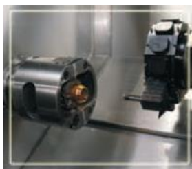
speciální indexové sklíčidlo SMW AXN nastavitelné ve 4 pozicích
