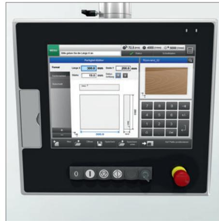
– **Steuerung per Touchpanel – Komfort von Anfang an.** Das Touchpanel mit dem großen 15" Bildschirm zeigt alle Werte und Einstellmöglichkeiten deutlich lesbar an. Im Startbild kann der Bediener zwischen verschiedenen Eingabemöglichkeiten wählen: entweder über die Eingabe der Achspositionen oder über die Eingabe der Werkstückmaße. Alle Anwendungen sind zentral steuerbar. Komfortabler geht es nicht.
