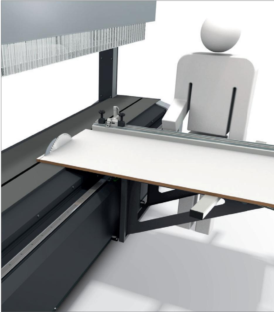
\_ Formatieren mit fixiertem Sägeaggregat
