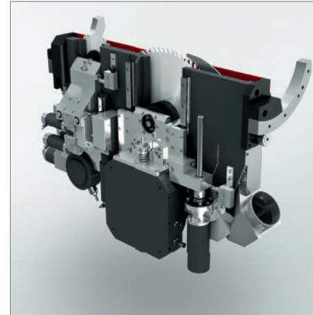
– **Sägeaggregat:** Die Altendorf 2e verfügt über ein einseitig bis 46° schwenkbares Sägeaggregat. Die Drehzahl lässt sich stufenlos von 1500–5000 U/min bestimmen. Motor Nennleistung: 3 kW. Motor Spitzenleistung: 6 kW. Leistungsreserve: 100%.
