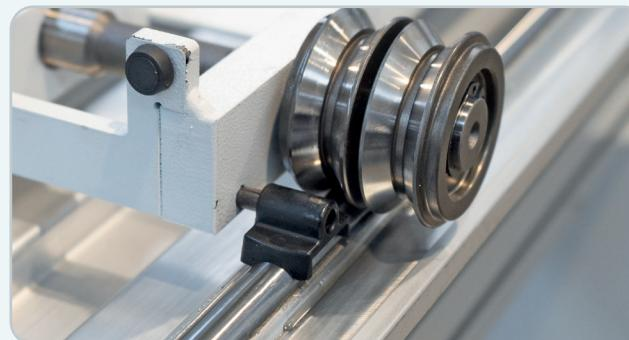
8 raschiatori per la pulizia delle guide di scorrimento del carrello.
