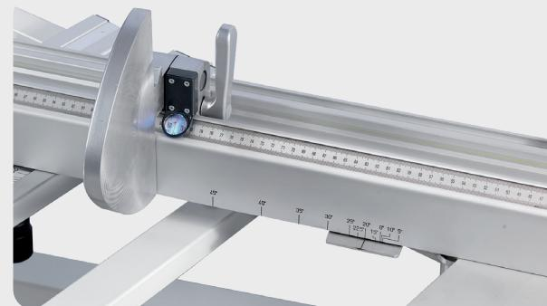
Fermo battuta maggiorato con bloccaggio a leva e visualizzazione quota con illuminazione a LED
