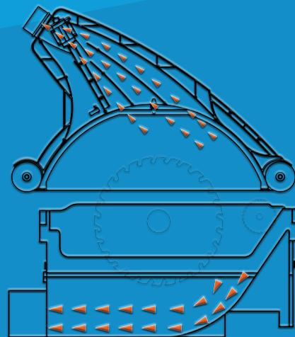
Hotte d'aspiration structurée avec convoyeurs internes pour la poussière, pour assurer une aspiration maximale (diamètre de la bouche 80 mm).
