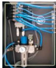
Centrální pneumatika FESTO pro snadnou údržbu
